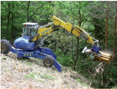
Kráčivý bagr Kaiser S 2 při práci s mulčovačem
