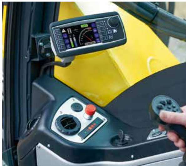
Joystick s 28 funkcemi, proporcionálními a digitálními, je navržen přesně pro kráčivá rypadla.
