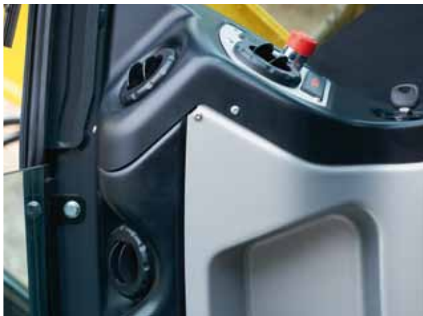
9 Luftaustrittsdüsen innerhalb der Kabine für Heizung und Klimaanlage
