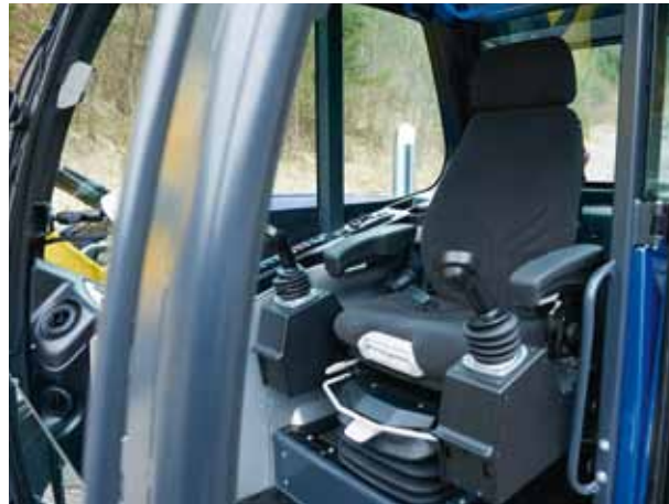
Ergonomischer, luftgefederter Sitz mit Heizung und Längsfederung
