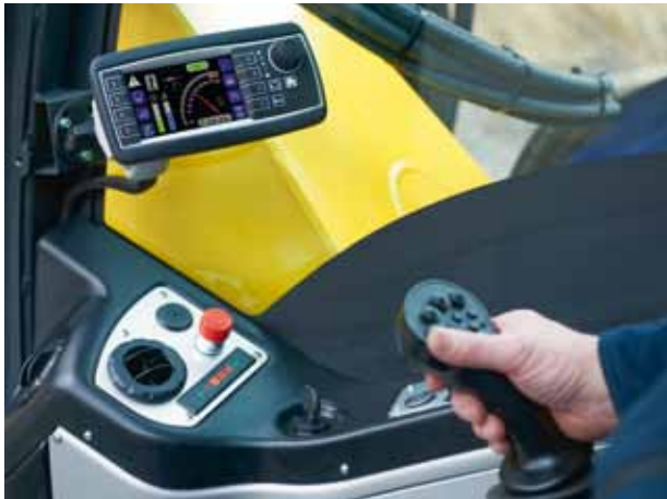
Joystick mit je 28 Funktionen, proportional und digital, speziell für den Mobil-Schreitbagger konzipiert
